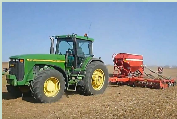
Protierozní agrotechnologie, výsev do svazky (zdroj You Tube-HORSCH Pronto 6 DC při jarním seti v různých podmínkách)
